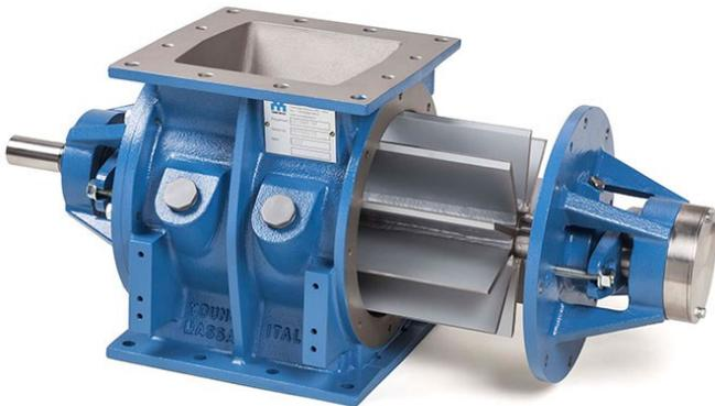
La valvola stella, nota anche come valvola rotativa o valvola a tenuta di pressione, è un dispositivo chiave nell'impianto di pirolisi. È installata tra la tramoggia di alimentazione e il reattore, e ha il compito di dosare il materiale in ingresso al reattore, garantendo una tenuta ermetica per prevenire perdite di gas e mantenere la pressione all'interno del sistema.
