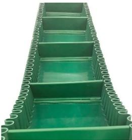
Il nastro trasportatore è un componente fondamentale dell'impianto di pirolisi, poiché ha il compito di trasferire il materiale pretrattato dal cassone intelligente alla tramoggia di alimentazione del reattore. Esso è costituito da una struttura di supporto e da una cinghia senza fine, realizzata in materiale resistente all'usura e alle condizioni operative, che scorre su rulli e pulegge motrici.
