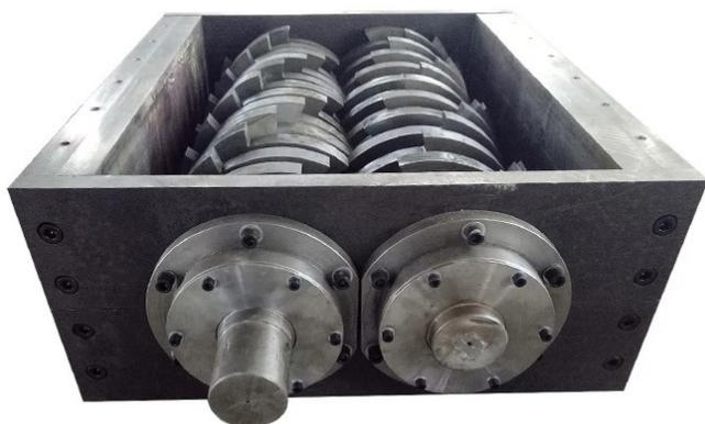
Il trituratore è un componente essenziale dell'impianto di pirolisi Greenplasma, il cui compito principale è ridurre i rifiuti solidi a frammenti di dimensioni più piccole, per facilitarne il trattamento all'interno del reattore. Di seguito sono descritte le principali caratteristiche e funzioni del trituratore:
