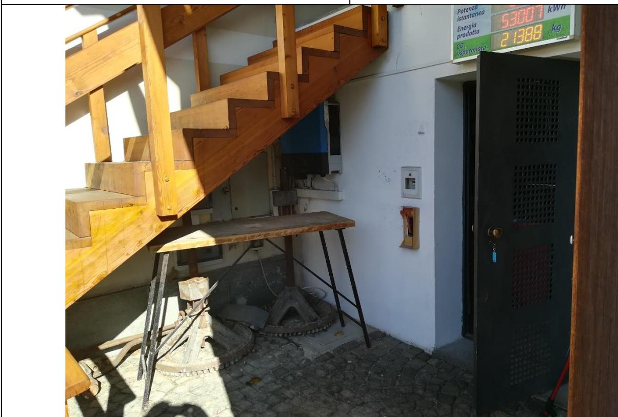
Porta di ingresso alla centrale termica oggetto di allargamento. Da dotare di aerazione  $>2500 \text{ cm}^2$
