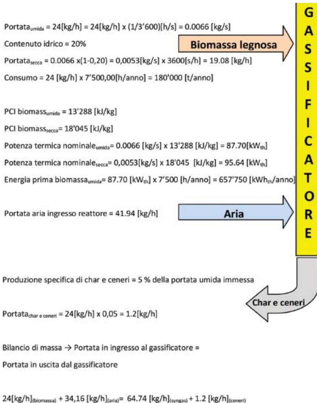
Figura 92 – Dalla brochure di ECO20x. Sono contabilizzati al dettaglio gli input del sistema di piro-gassificazione.
