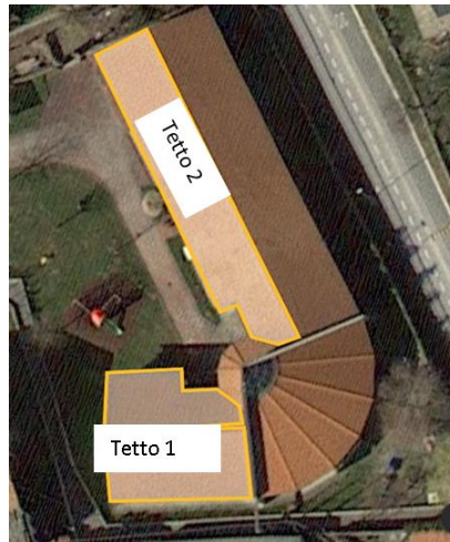
Figura 81 – Visualizzazione dei tetti esposti a sud della Scuola Materna di Bagnolo e prescelti per il posizionamento dei pannelli FV.
