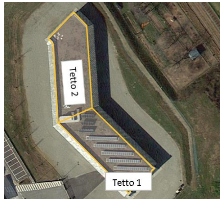
Figura 83 – Visualizzazione dei tetti esposti a sud della Scuola Elementare di Bagnolo e prescelti per il posizionamento dei pannelli FV.
